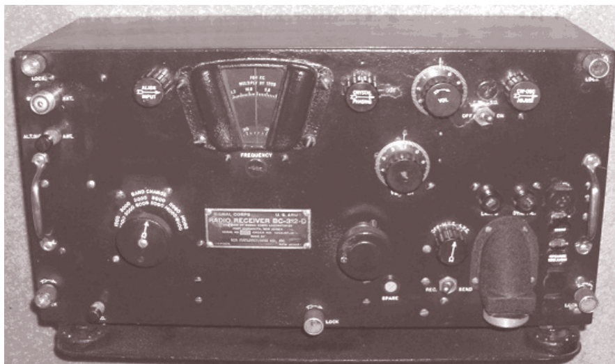
מקלט ת"ג BC312, מעודפי הצבא האמריקאי, שהיה פופולרי בשימוש הגדעונים מקלט עם 9 שפופרות לתחום התדרים 1.5 עד 18 מה"צ, שייצורו החל עוד בשנות השלושים.
